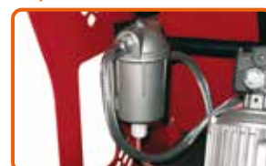
Filtro de gasoil con precalentamiento. Cod.: 02AC548
